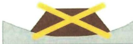
Anlage von Oberbodenmieten maximale Schutthöhe 2 m
