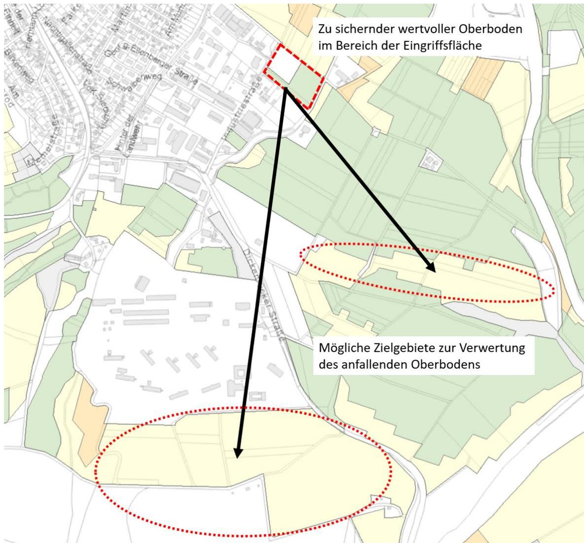
Anfallender Oberboden der geplanten Eingriffsfläche der nicht innerhalb des Baufeldes einer Wiederverwertung zugeführt werden kann, ist unter Beachtung der DIN- Normen auf die im Plan oben dargestellten landwirtschaftlichen Flächen für eine Bodenverbesserung der hier vorhandenen Ackerflächen einzusetzen. Die auf den Hangflächen vorhandenen Oberböden sind flachgründig und minderwertiger als der im Baufeld anfallende Oberboden.
