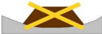
Anlage von Oberbodenmieten maximale Schutthöhe 2 m
